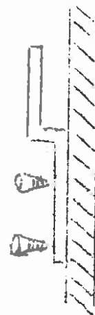
Obr. 2 - Klouba z pásové oceli a její montáž na závěsnou lištu
