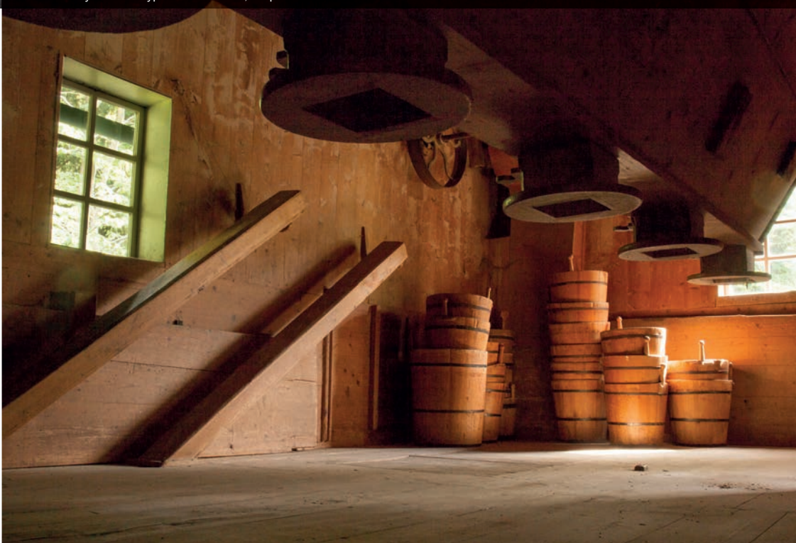
Mlýnice s násypkami na melivo, krupice a mouku a částmi transmisí a řemení
