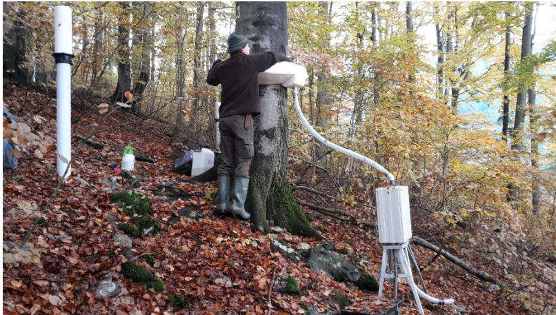
Odběr atmosférických srážek a měření stoku po kmeni na lokalitě Bažinky.
